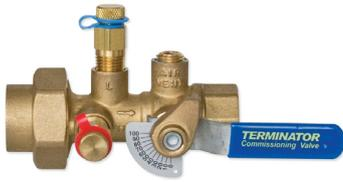
Válvula de equilibrado manual con regulación. Posee memoria de posición y venturi intercambiable para la lectura del caudal (válvula patentada). Conexiones H x H racor-manguito. Set de dos tomas de presión incluidas.
