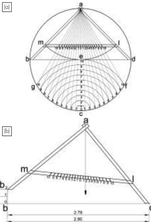
Figura 6. a) Obtención del nivel ordinario descrito por fray Andrés de San Miguel. b) Comprobación de la exactitud del aparato al elevar la pierna *ab* a alturas incrementadas consecutivamente medio *pie* y verificar que la cuerda con la plomada pasa por la línea de la traviesa que se obtuvo con el método de fray Andrés de San Miguel.
