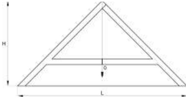
Figura 2. Nivel de albañil o disímetro. Ilustración que aparece en Faustino Bastús, *Manual del agrimensor que contiene, a más de las mediciones, las tablas de reducción y un diccionario de voces técnicas*, París, Librería de Rosa y Bouret, 1861, p. 51.
