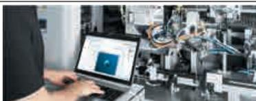
Sistema de accionamiento operativo con rapidez y seguridad: Festo Automation Suite combina parametrización, programación y mantenimiento de componentes de Festo en un programa y permite la puesta en funcionamiento de todo el conjunto de accionamiento, desde el sistema mecánico hasta el controlador.
