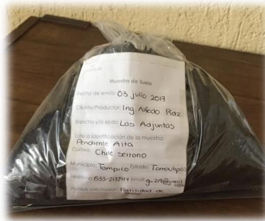
Figura 3. Muestra de suelo empacada en bolsa de plástico debidamente etiquetada
