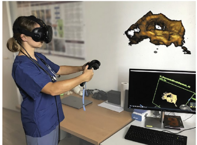
FIG.12. Configuración de realidad virtual (VR). Un usuario hace uso de un visor de realidad virtual y manipula controladores. La vista del usuario se ve encima del monitor de escritorio. Se espera que las versiones futuras sean inalámbricas.
