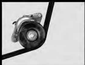
Oscilación excesiva del brazo del tensor
