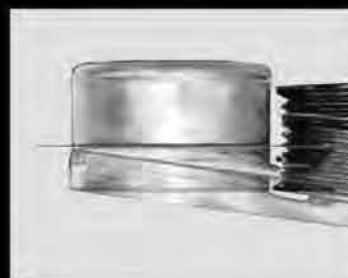
Desalineación del brazo del tensor
