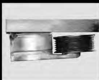
Desalineación del tensor
