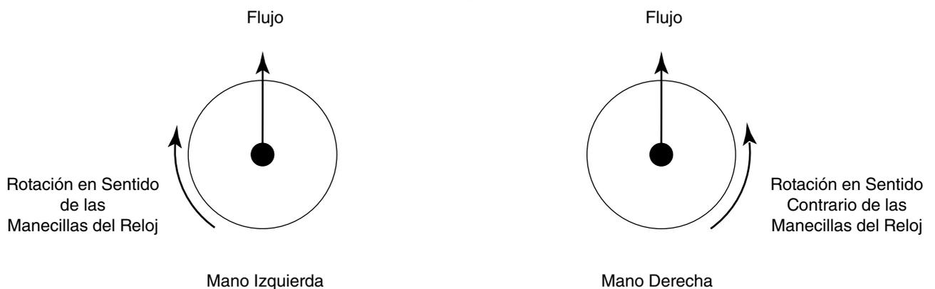
Estos diagramas nos dan un método sencillo para determinar la rotación del helicoidal. Cuando el flujo de material se aleje del extremo desde donde estamos observando, un helicoidal mano derecha girará en el sentido contrario a las manecillas del reloj y un helicoidal mano izquierda girará en el sentido a las manecillas del reloj, como está indicado por las flechas.
