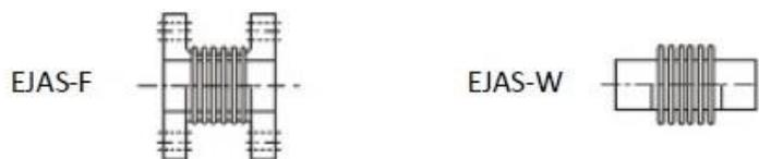
Exemplo de solicitação de uma junta de expansão DN 3" x 240 mm com terminais para solda: EJAS-W-2
