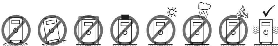
Figura 3-1 Precauciones de instalación y uso del UPS
