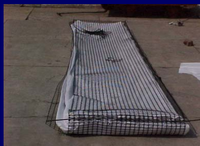
Colchoneta con revestimiento interno de filtro PAVITEX®, para ser llenada con arena.
