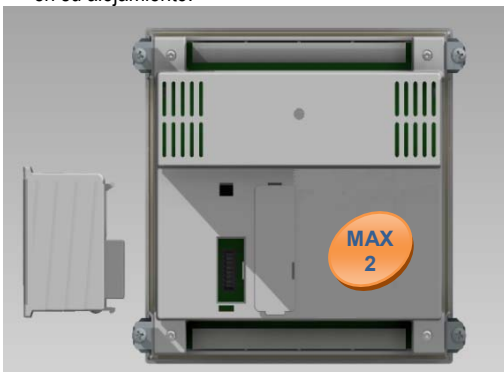
Montaje de los módulos de expansión
