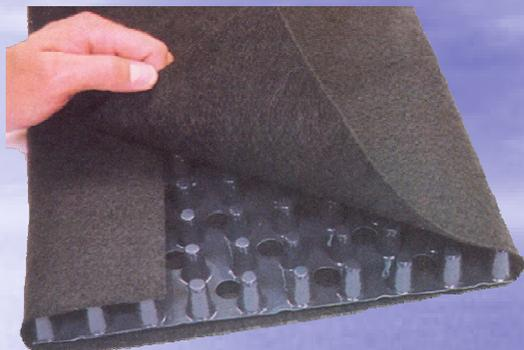
*El Dren Prefabricado AKUADREN® se compone de un núcleo drenante cubierto con una cubierta de filtro textil. Posee muy alta capacidad de flujo y sus componentes son fabricados con polímeros no biodegradables.*
