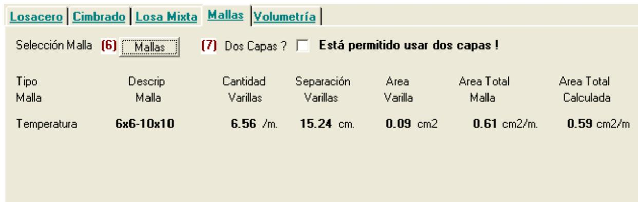
Figura 5.9.20: Pantalla de la Caja de Mallas, después de seleccionar el área de acero.
