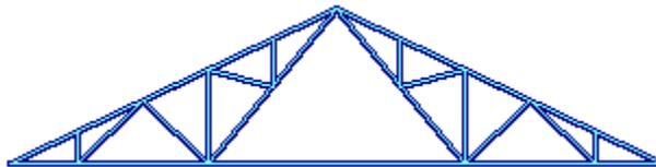
Figura 2.011d: Armadura Fink, 10 Paneles.
