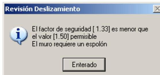
Figura 7.29a: Falla en la Revisión de Deslizamiento.
