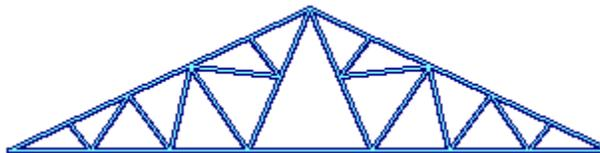
Figura 2.011e: Armadura Fink, 10 Paneles, Abanico.
