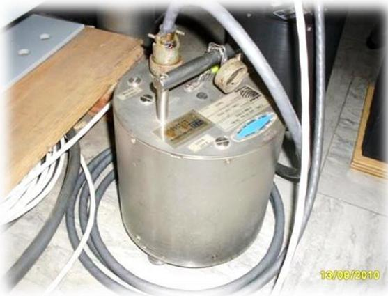
Figura 6. Sismómetro de banda ancha marca Guralp modelo 6TD.
