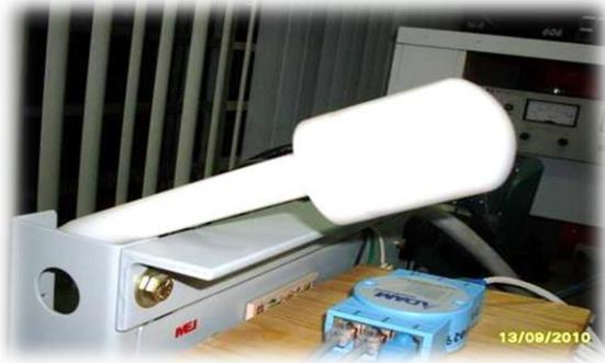
Figura 7. Reloj GPS de alta precisión marca Guralp modelo CMG-GPS2.
