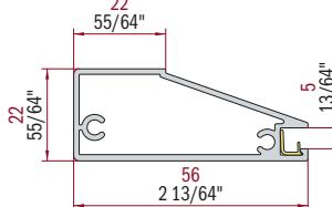
SEAL GASKET FOR 4 MM GLASS   JOINT PLATE   SCREWS
