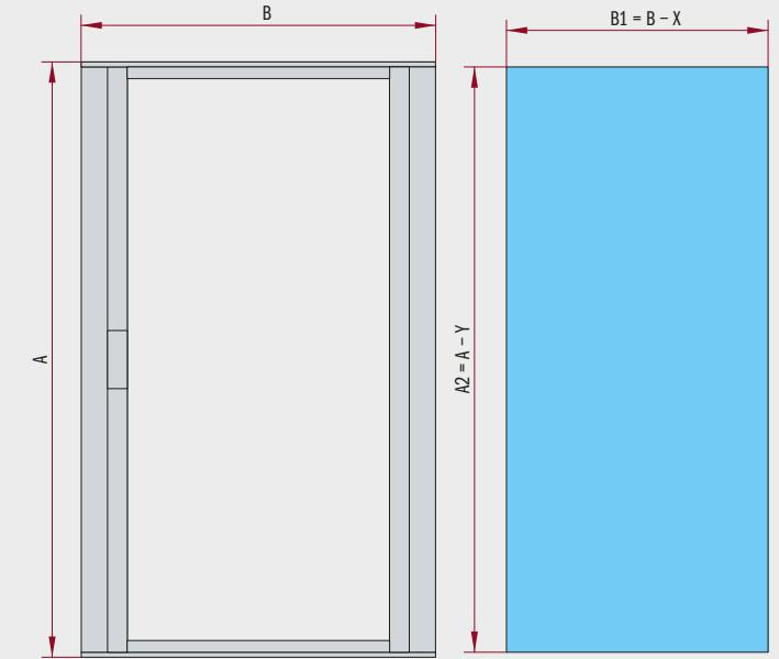
Doors with 45-degree junction - Portes avec jonction à 45 degrés - Puertas con uniones de 45 grados
