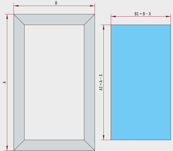
Doors with 90-degree junction - Portes avec jonction à 90 degrés
