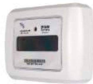
Es un dispositivo a través del cual se presenta en forma visual el registro de la generación de energía eléctrica. Tiene la capacidad de mostrar las lecturas que le envíe el microinversor o los microinversores asociados de forma gráfica por medio de un portal web. Este instrumento indicador de generación de energía eléctrica utiliza un modem de comunicación PLC (Power Line Communication), que se asocia a los
