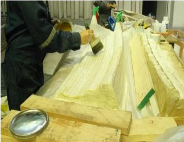
Las superficies tratadas con FRIGO ATTACH (ANTIADHERENTE), quedan libres de la porosidad originada por los poliuretanos y estos últimos son retirados de una manera fácil y sin esfuerzo eliminándose en una sola pieza ya que FRIGO ATTACH (ANTIADHERENTE), no permite la adherencia ni la formación de nuevas superficies.
