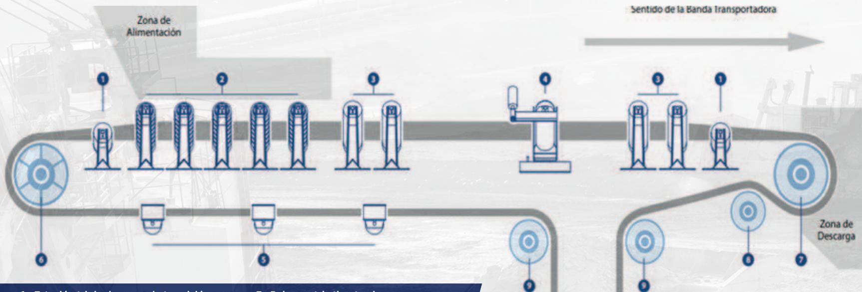
1.- Estación triple de carga de transición
