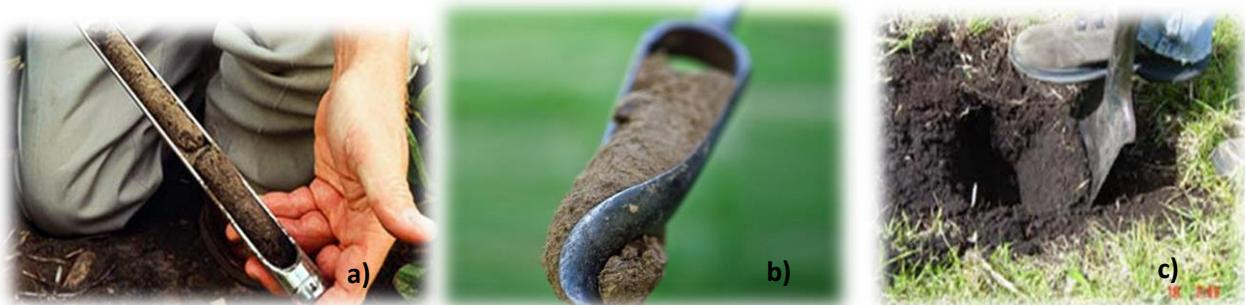
Figura 2. Utensilios necesarios para la toma de muestras de suelos. a) Tubo hueco, b) Barrena, c) Pala
