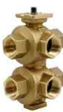
Válvula de bola a seis vías para equipos a 4 tubos para la gestión automática de la conmutación verano-invierno de techos radiantes, unidades fan Coil y vigas frías.
