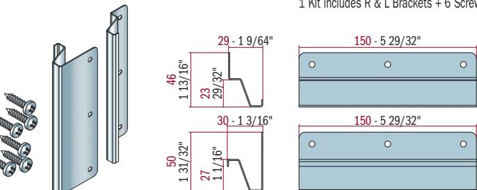
**SPACER BRACKETS FOR VERTICAL GOLA****SUPPORT DE ESPACEMENT POUR GOLA VERTICAL****SOPORTE ESPACIADOR**
