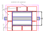
Sección Constructiva ladrillo r/r juntado con mortero 1:4
