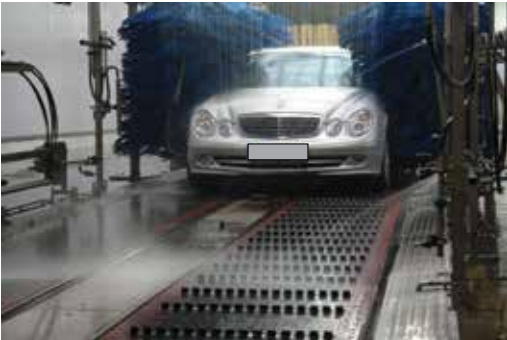
Malla 6999 serie con empujadores T2 para lavado exterior de vehículos
