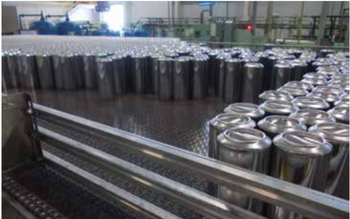
Elevación de latas con sistema de vacío empleando la malla 5935
