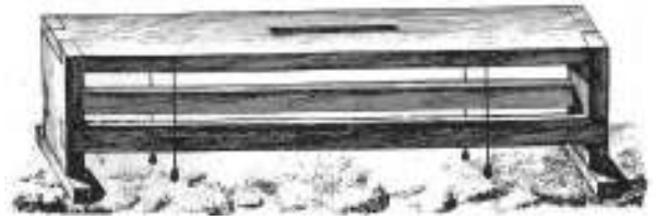
Figura 2. Corobate. Marco Vitruvio Polión, Los diez libros de arquitectura , lám. II, fig. 7, Madrid, Akal, 2001 [1787].
