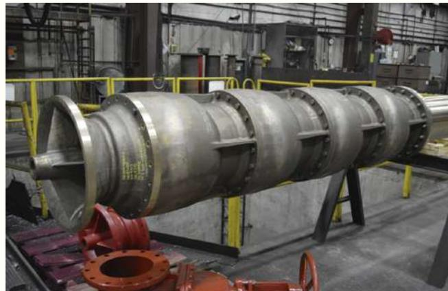
Bomba tipo turbina vertical fabricada en Bronce Ni-Al, flecha en monel K-500 instalada en Perforadora central
