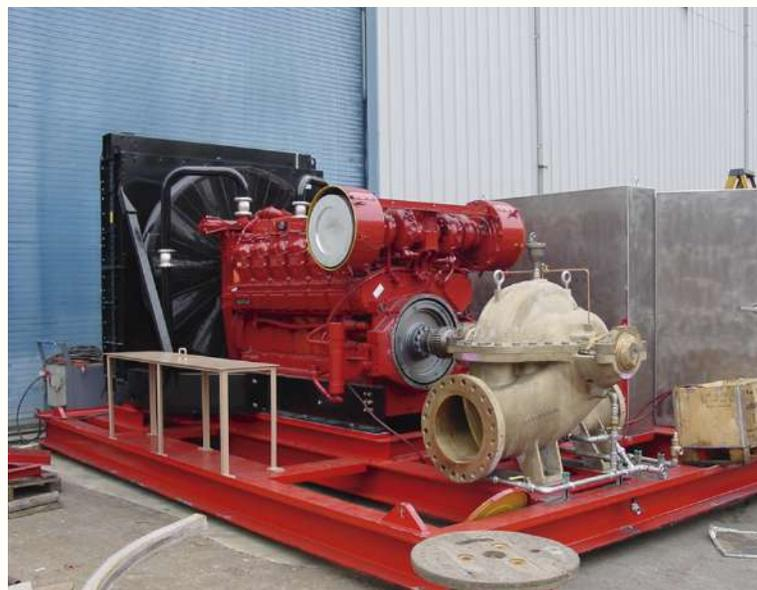
Bomba horizontal fabricada en Bronce Ni-Al acoplada a un motor de combustión interna con radiador.
