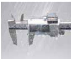
COOLANT PROOF<sup>※1</sup> es el término universal para los instrumentos de medición Digimatic de Mitutoyo que no solo son resistentes al ingreso de polvo y agua, sino también al deterioro de los materiales debido al contacto con el aceite de corte o los fluidos refrigerantes en uso normal.
