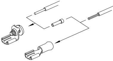
Die Anschlüsse sind für Quetsch-Kabelschuhe 6,3 mm ausgelegt. Litzen- und starre Kabel entsprechend konfektionieren.
