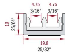
ALUMINUM PROFILE FOR THE REALIZATION OF SLIDING DOORS FOR THE SHELVING STRUCTURE.
