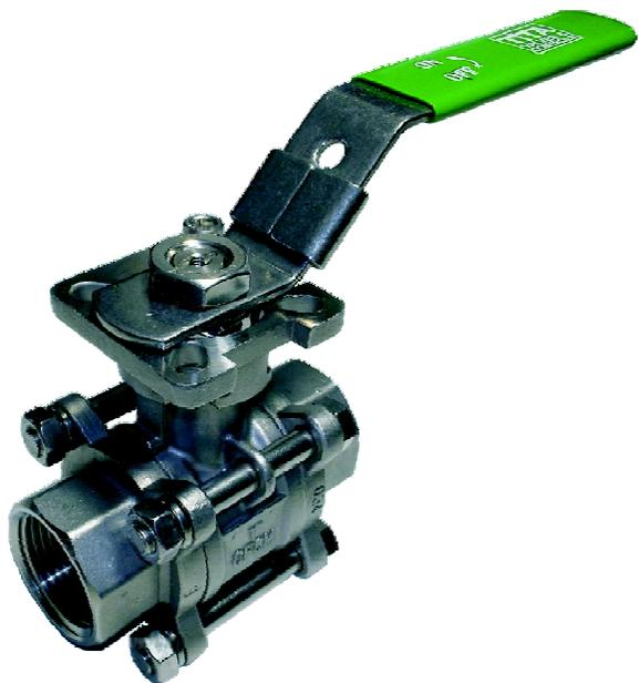
Las válvulas de bola de la serie T35M de TITA VALVES & CONTROLS diseño en 3 piezas para fácil y rápido mantenimiento, están fabricadas con alta calidad y precisión en la fundición. Operación manual. Puerto completo totalmente maquinado. Vástago antiexpulsión. Máxima presión de operación 1000PSI WOG para tamaños de 1/4" a 2" y 800 PSI WOG para tamaños de 2.5" a 4". Aprobada por PED 97/23EC.
