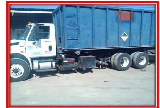
Camiones tipo roll-off para traslado de tolvas de 15 y 23 m<sup>3</sup>
