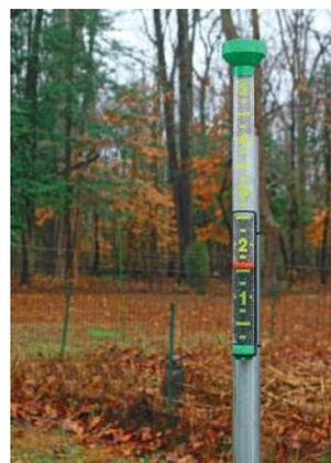
Figura 5.5. El pluviómetro permite conocer con precisión el volumen de lluvia.
