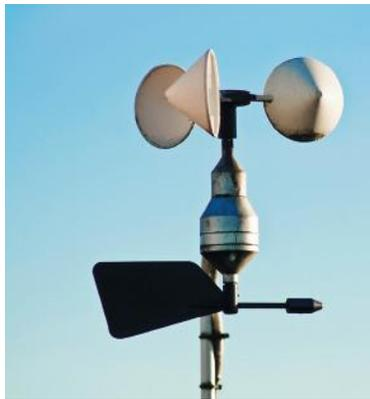
Figura 5.13. El anemómetro nos permite conocer con precisión la velocidad del viento.
