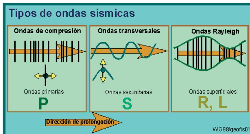
Figura 3.9. Como observas en el esquema, las ondas sísmicas son de tipos diversos y, según los expertos, las de mayor riesgo para las poblaciones son las superficiales.
