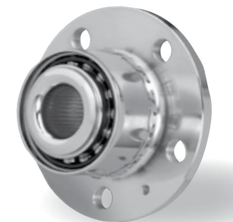
Combinan la rentabilidad de los rodamientos de rueda de la 1<sup>a</sup> generación con las ventajas de la integración de una brida de rueda para fijar el disco de freno y la llanta. La maza (Hub) se asegura a la mangueta con un innovador anillo de seguridad que también garantiza la sujeción axial del anillo exterior del rodamiento.
