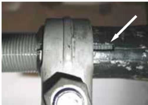
Correcto: la rosca en ambas terminales debe enroscarse por completo hasta llenar la cavidad de la ranura del tubo transversal.
