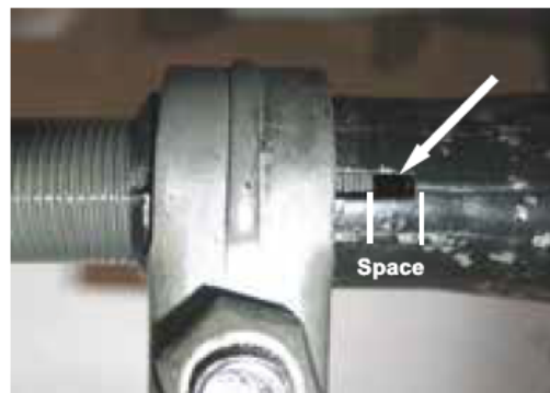
Incorrecto: La rosca de la terminal No está totalmente insertada en la cavidad de la ranura del tubo transversal.
