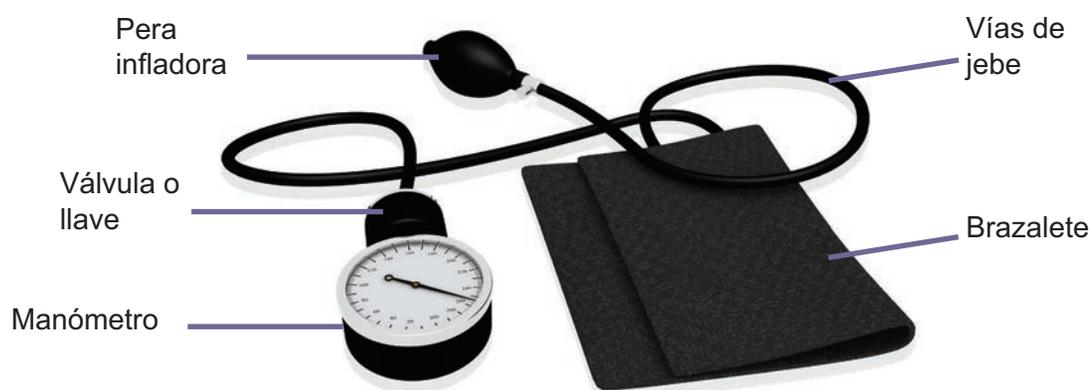
Figura 1.13. Partes de un esfigmomanómetro.
