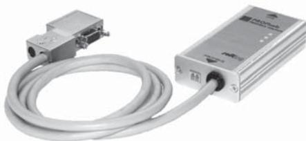
PROFIusb es un interfaz PROFIBUS para PC. PROFIusb proporciona acceso de alto rendimiento a PROFIBUS y permite realizar tareas de configuración de red o parametrización de equipos en sistemas PROFIBUS. El PROFIusb actúa como maestro PROFIBUS de clase 1 o 2 para cualquier velocidad de transmisión de datos inferior a 12 Mbits/s.
