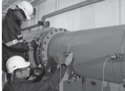
Prosonic Flow 93T utilizado para verificar la coherencia de los valores medidos por un caudalímetro electromagnético
