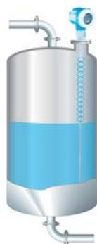
**Medición de nivel por microondas guiadas**
