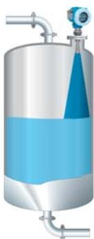
**Medición de nivel por microondas**
