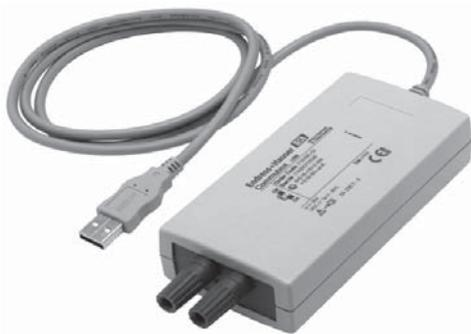
La Commubox FXA195 conecta transmisores inteligentes e intrínsecamente seguros, que están dotados con el protocolo HART, con el puerto USB de un ordenador personal. Esta conexión posibilita la puesta en marcha y configuración remota de transmisores mediante el software de configuración FieldCare de Endress+Hauser
