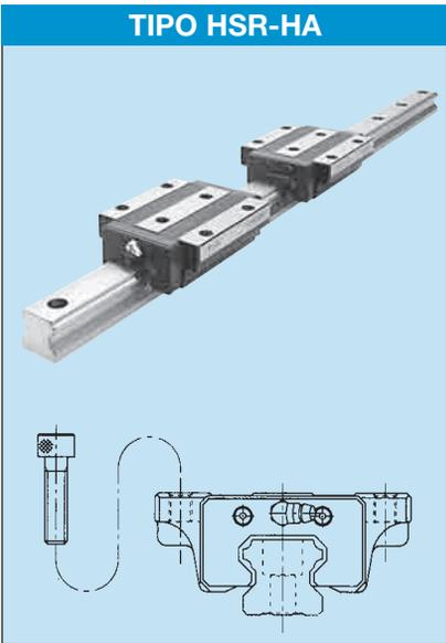
Este tipo tiene el mismo corte transversal que el tipo HSR-CA pero tiene un bloque de movimiento lineal más largo. El bloque de movimiento lineal más largo aloja un mayor número de bolas de modo que puede transportar cargas ultra pesadas.
