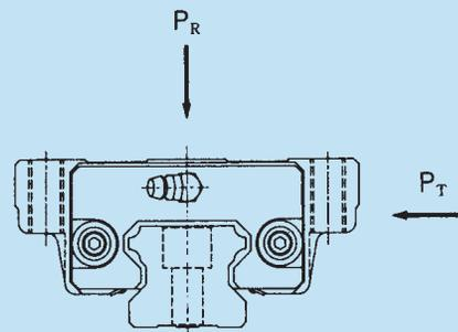
Fig. 6 Carga equivalente única para el sistema de movimiento lineal
