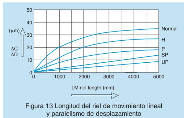
Figura 13 Longitud del riel de movimiento lineal y paralelismo de desplazamiento
