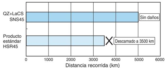
\*En el caso de ser usado en ambientes hostiles, utilizar el lubricador QZ en combinación con los rascadores de contacto LaCS (Ver pág. 152).
