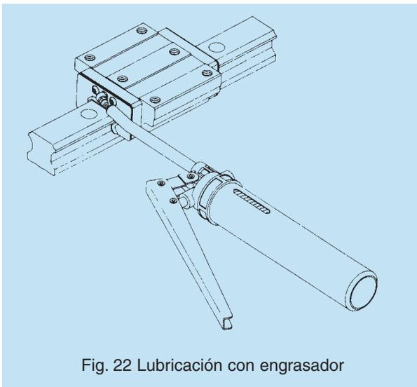
Fig. 22 Lubricación con engrasador
