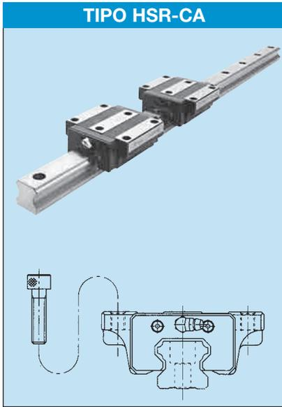
El bloque de movimiento lineal tiene orificios para tornillos auto-roscantes de modo que es apropiado para la construcción superpuesta para un fácil montaje.
