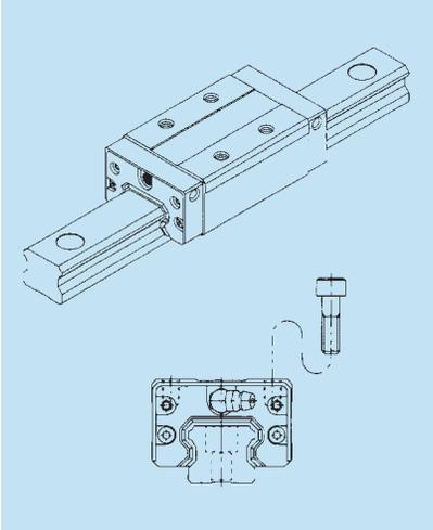
El bloque del tipo SHS-V es angosto y al tener orificios roscados maquinados en la superficie de montaje, se puede poner en el sistema de acumulación. También puede utilizarse sobre una tabla de ancho limitado.
