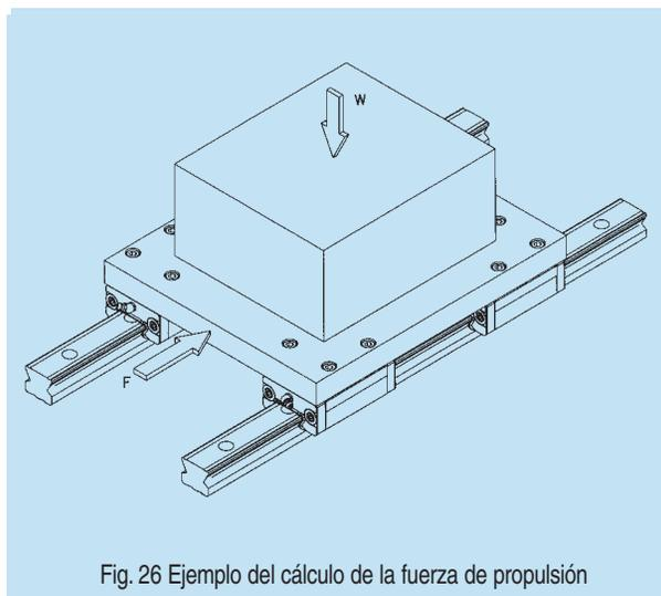
Fig. 26 Ejemplo del cálculo de la fuerza de propulsión
