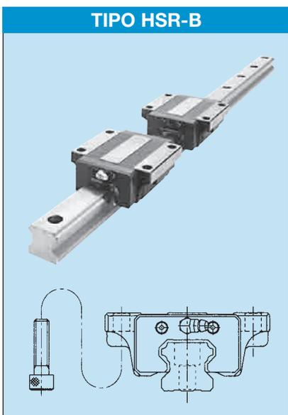
El bloque de movimiento lineal está instalado con pernos que se insertan por debajo del bloque. Esto es conveniente cuando la tabla no puede tener orificios pasantes.
