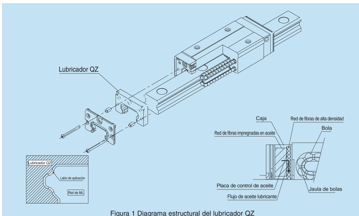
Figura 1 Diagrama estructural del lubricador QZ
