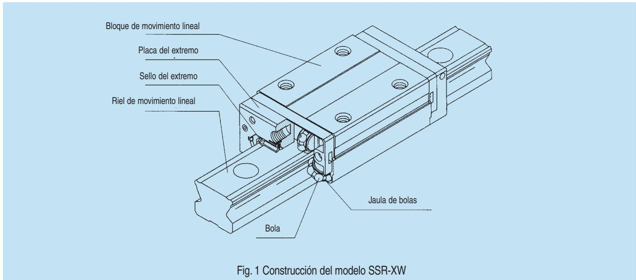
Fig. 1 Construcción del modelo SSR-XW
