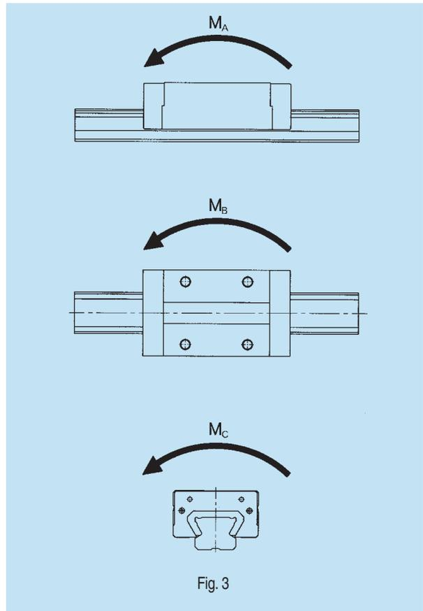
En el tipo SSR, un bloque de movimiento lineal soporta momentos en todas las direcciones. En la tabla 3 se incluyen los momentos admisibles en las direcciones M<sub>A</sub>, M<sub>B</sub>, y M<sub>C</sub> de un solo bloque de movimiento lineal y de bloques dobles puestos uno encima del otro (no hay información sobre la dirección M<sub>C</sub>).
