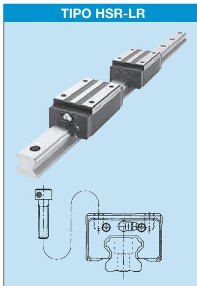
Este tipo tiene el mismo corte transversal que el tipo HSR-R pero tiene un bloque de movimiento lineal más largo. El bloque de movimiento lineal más largo aloja un mayor número de bolas de modo que puede transportar cargas ultra pesadas.
