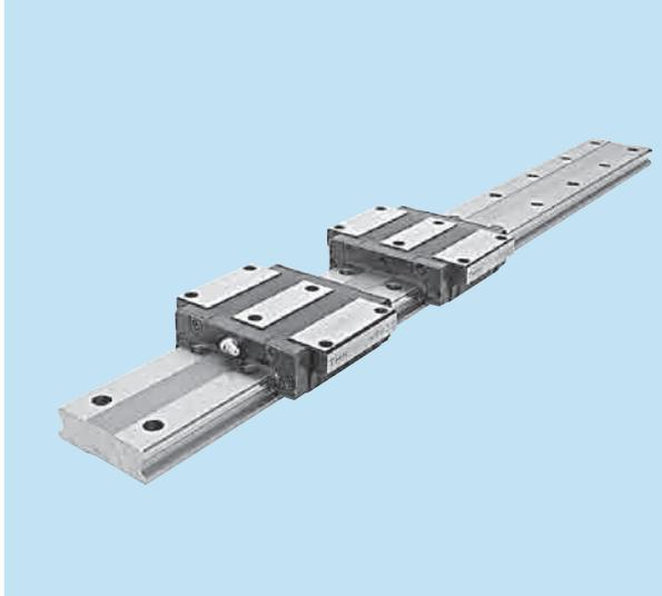
Este es un modelo ancho, de bajo perfil que tiene iguales valores de carga en los cuatro sentidos. Los pernos de montaje se pueden insertar desde arriba o por debajo del bloque de movimiento lineal.
