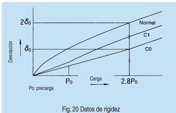
La Fig. 20 muestra que el efecto de la precarga es de hasta 2.8 veces la cantidad real de precarga. Comparadas con guías que no están precargadas, las desviaciones de las guías de movimiento lineal precargadas se reducen significativamente con la misma carga, lo que demuestra un aumento sustancial de la rigidez.
