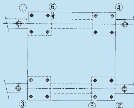
Fig. 33 Secuencia de instalación de los bloques de movimiento lineal
