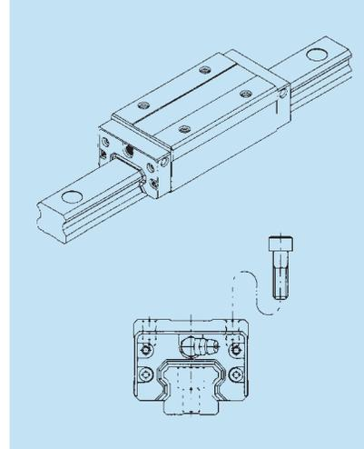
EL tipo SHS-LR tiene el mismo corte transversal que el tipo SHS-R. Si la cantidad de bolas es mayor puede soportar cargas ultra pesadas.
