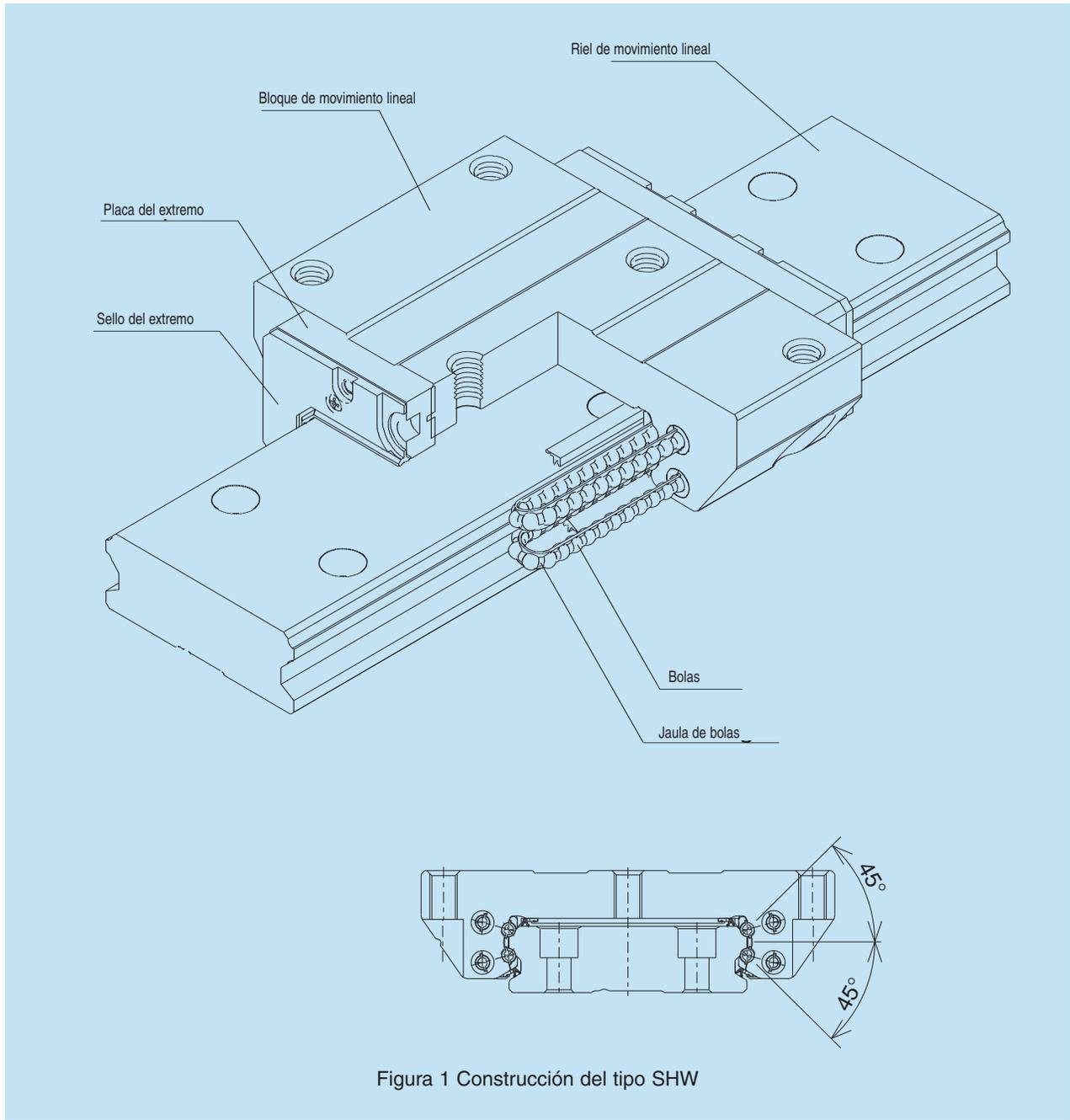
Figura 1 Construcción del tipo SHW
