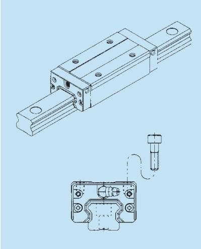
El tipo SHS-LV tiene el mismo corte transversal que el tipo SHS-V. Si la cantidad de bolas es mayor puede soportar cargas ultra pesadas.
