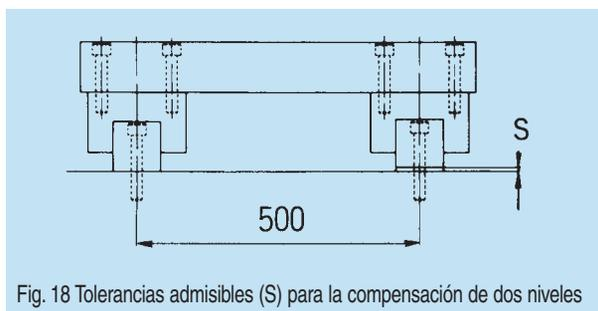
Fig. 18 Tolerancias admisibles (S) para la compensación de dos niveles
