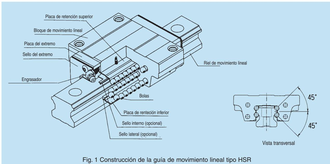
Fig. 1 Construcción de la guía de movimiento lineal tipo HSR
