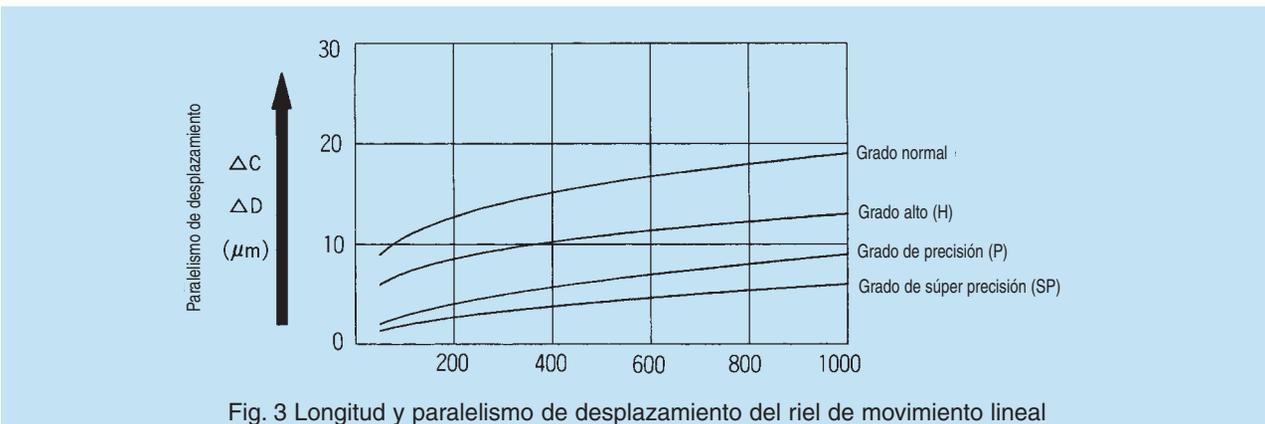
Fig. 3 Longitud y paralelismo de desplazamiento del riel de movimiento lineal
