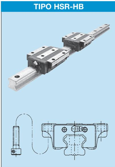
Este tipo tiene el mismo corte transversal que el tipo HSR-CB pero tiene un bloque de movimiento lineal más largo. El bloque de movimiento lineal más largo aloja un mayor número de bolas de modo que puede transportar cargas ultra pesadas.
