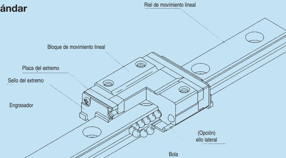
Fig. 1 Construcción de la guía miniatura de movimiento lineal tipo RSR...Z
