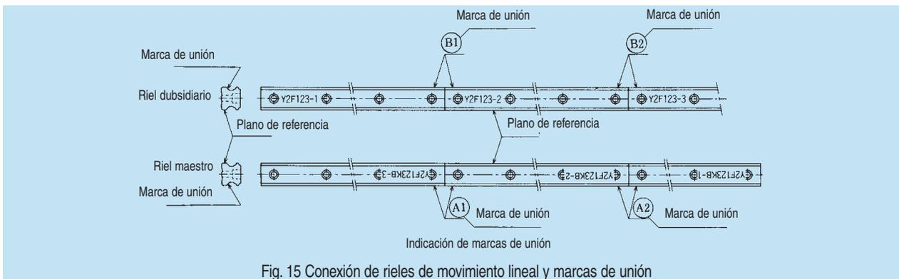
Fig. 15 Conexión de rieles de movimiento lineal y marcas de unión
