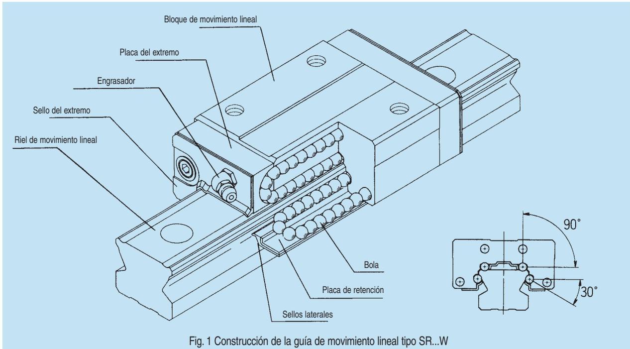
Fig. 1 Construcción de la guía de movimiento lineal tipo SR...W
