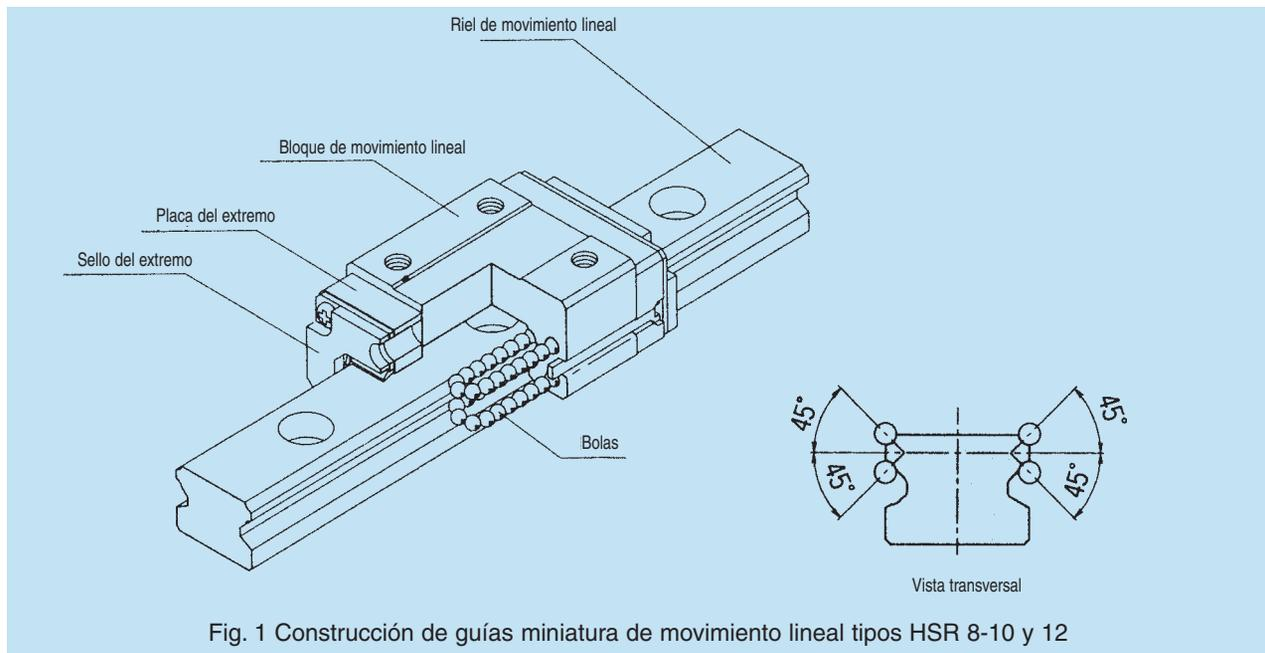
Fig. 1 Construcción de guías miniatura de movimiento lineal tipos HSR 8-10 y 12
