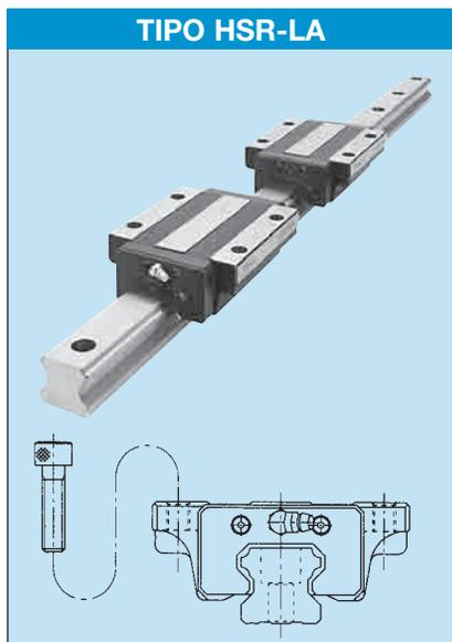
Este tipo tiene el mismo corte transversal que el tipo HSR-A pero tiene un bloque de movimiento lineal más largo. El bloque de movimiento lineal más largo aloja un mayor número de bolas de modo que puede transportar cargas ultra pesadas.
