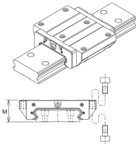
El tipo SHW-CA se caracteriza por una construcción ancha y un bajo centro de gravedad. Puede soportar carga en las 4 direcciones. Los orificios de instalación del bloque de movimiento lineal son roscados y escariados desde la parte inferior del reborde, lo que permite montar el bloque de movimiento lineal desde arriba o abajo (fijado en los 4 puntos).
