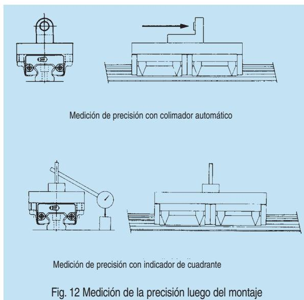
Fig. 12 Medición de la precisión luego del montaje
