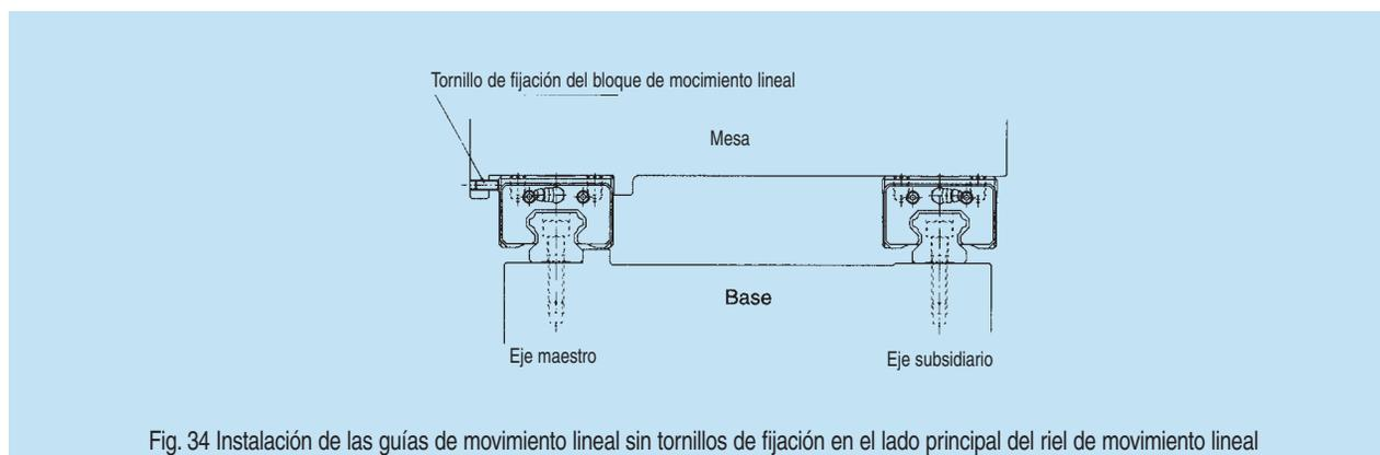
Fig. 34 Instalación de las guías de movimiento lineal sin tornillos de fijación en el lado principal del riel de movimiento lineal
