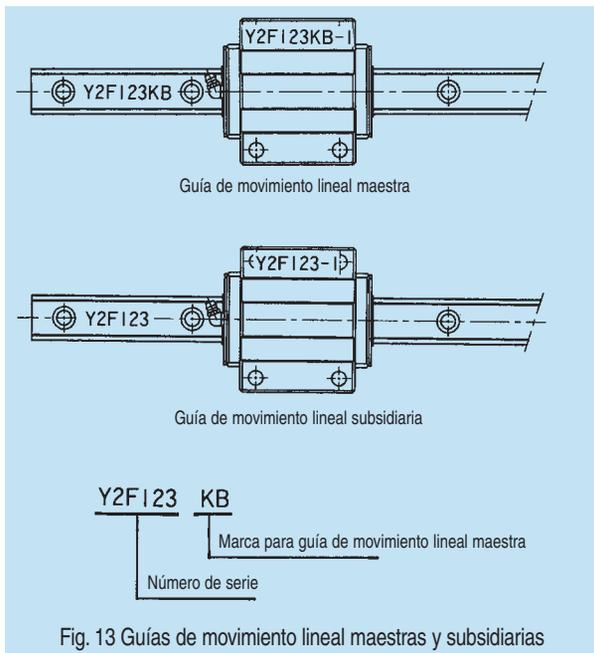
Fig. 13 Guías de movimiento lineal maestras y subsidiarias
