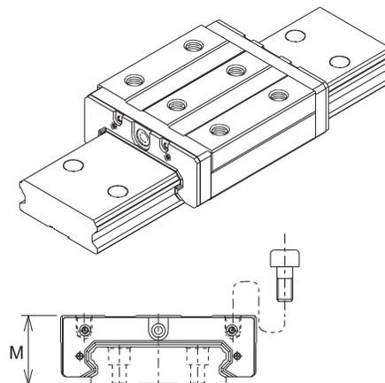
El tipo SHW-CR es un diseño compacto que presenta una construcción ancha y un bajo centro de gravedad. El bloque de movimiento lineal se instala con los orificios roscados en la parte superior.
