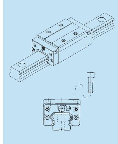
El bloque del tipo SHS-R es angosto y al tener orificios roscados maquinados en la superficie de montaje, se puede poner en el sistema de acumulación. La altura de este tipo es la misma que la del tipo HSR-R.
