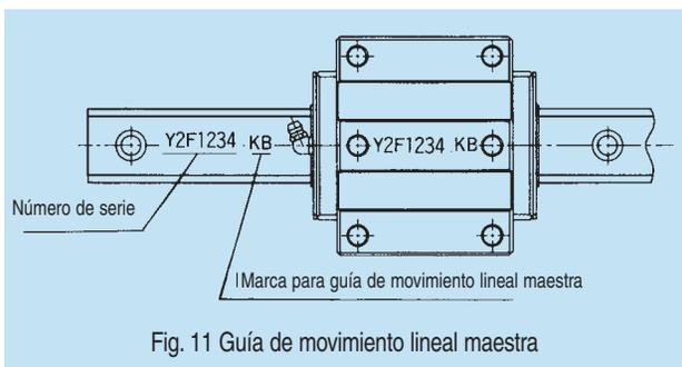
Fig. 11 Guía de movimiento lineal maestra
