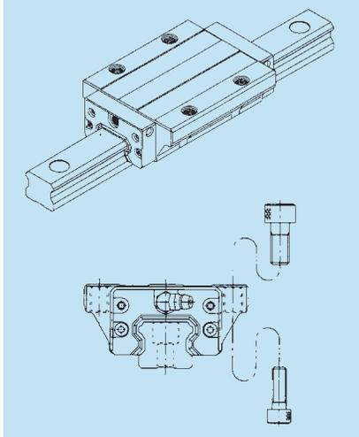
El tipo SHS-LC tiene el mismo corte transversal que el tipo SHS-C. Si la cantidad de bolas es mayor puede soportar cargas ultra pesadas.
