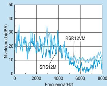
Figura 8 Comparación de los niveles de ruido en los tipos SRS12M y RSR12VM - (velocidad 100 mm/min)
