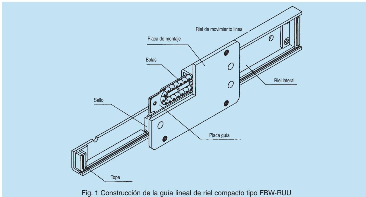
Fig. 1 Construcción de la guía lineal de riel compacto tipo FBW-RUU
