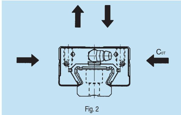
El tipo SSR soporta cargas en las cuatro direcciones: radial, radial inversa y en las dos direcciones laterales.
